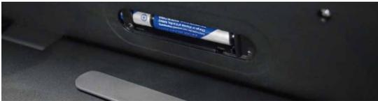
Die Waage kann auch über eine Batterie betrieben werden. Dafür müssen 2 Stück AAA Batterien in das Batteriefach gesteckt werden.
