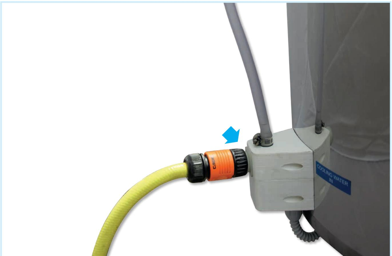
**5. Schlauch an „COOLING WATER IN“ anbringen (Anschluss und Schlauch nicht inkludiert).**
